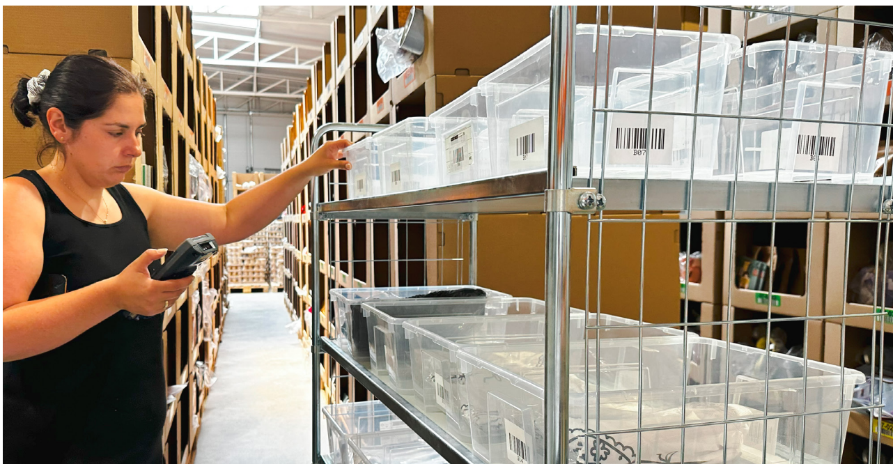
Kompletacja multi order picking z wykorzystaniem wózka i pojemników oznaczonych kodem kreskowym.
