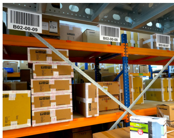
Tablice powieszane - oznakowanie miejsc odkładczych.
