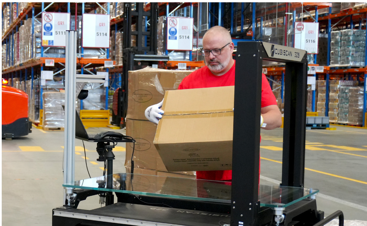
Ułożenie wymiarowanego opakowania na szybie urządzenia.
