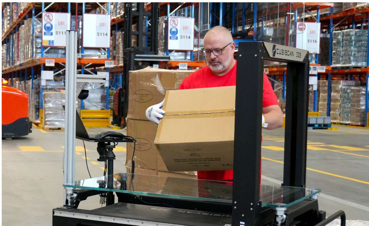
Ułożenie wymiarowanego opakowania na szybie urządzenia.
